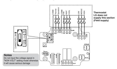
• For input contact voltage : DC 12 V, 24 V~
